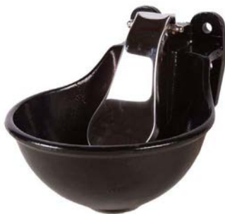
119190 Öntöttvas itató két rétegben szinterezett cserélhető bronz szeleppel, 1/2" vízcsatlakozás, rozsdamentes nyomónyelv
